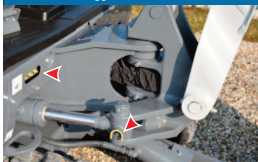
Passaggio tubazioni lineare
