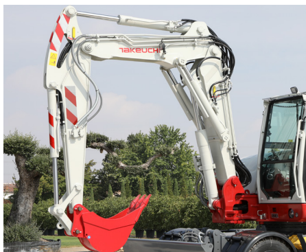
CATARIFRANGENTI BICOLORE SUL BRACCIO
