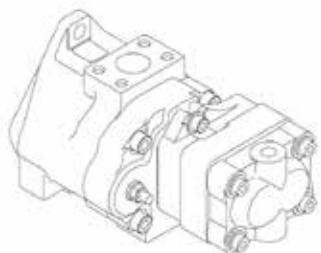
La pompa a portata variabile regola, gestisce la portata e la pressione in funzione del carico sul sistema idraulico, per incrementare la forza di scavo e ridurre i tempi ciclo.
